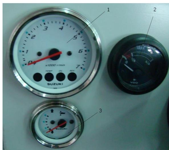
1. Тахометр с сигнальными лампами;
