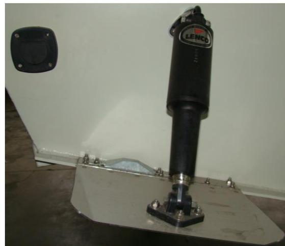
Электрическая транцевая плита
