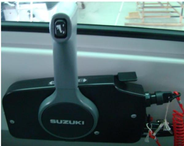
Управление двигателем (ручка газ-реверс)
