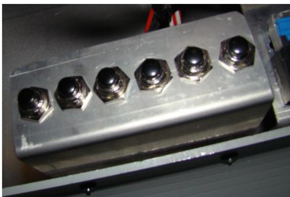
Блок тепловых реле (установлены в приборной консоли).
