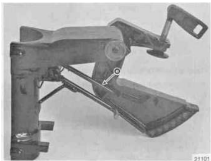
a – Рычаг механизма наклона в левобортном транцевом кронштейне
