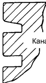
Канавки поршневых колец в увеличенном виде
