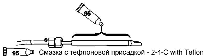
2. Вставить трос рулевого управления в трубу механизма наклона. Затянуть гайку троса рулевого управления до указанного ниже усилия затягивания.
